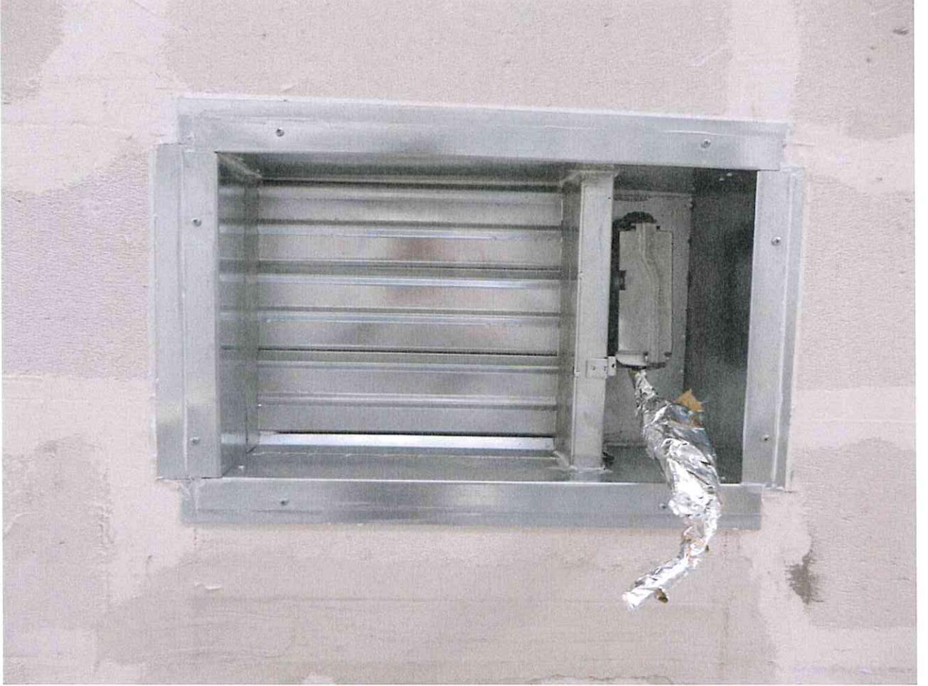
Şekil C1: Numunenin aleve maruz kalmayan tarafının test öncesi görünümü.
