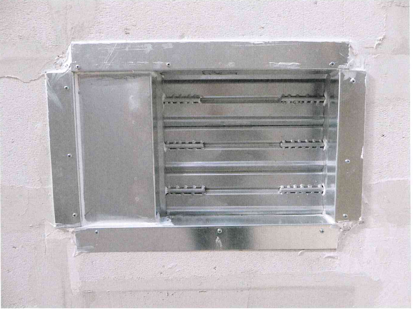
Şekil C2: Numunenin aleve maruz kalan tarafının test öncesi görünümü.
