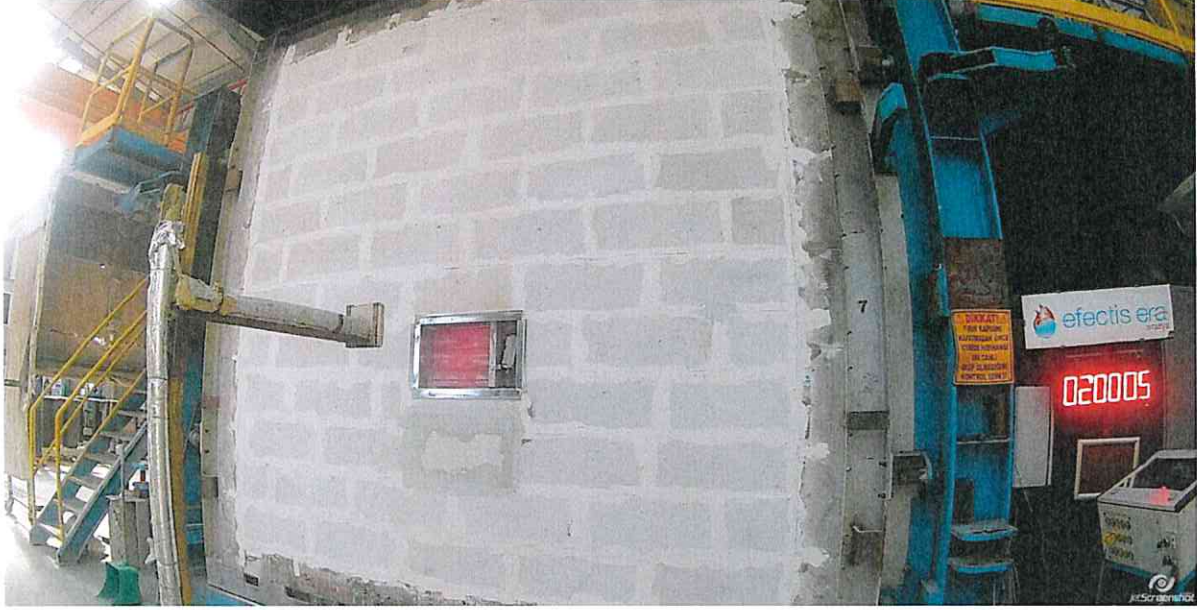
Şekil C3: Numunenin, testin 120. dakikasındaki görünümü.
