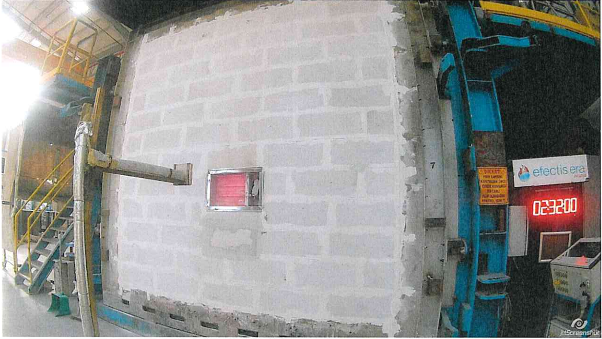
Şekil C4: Numunenin test sonundaki görünümü.
